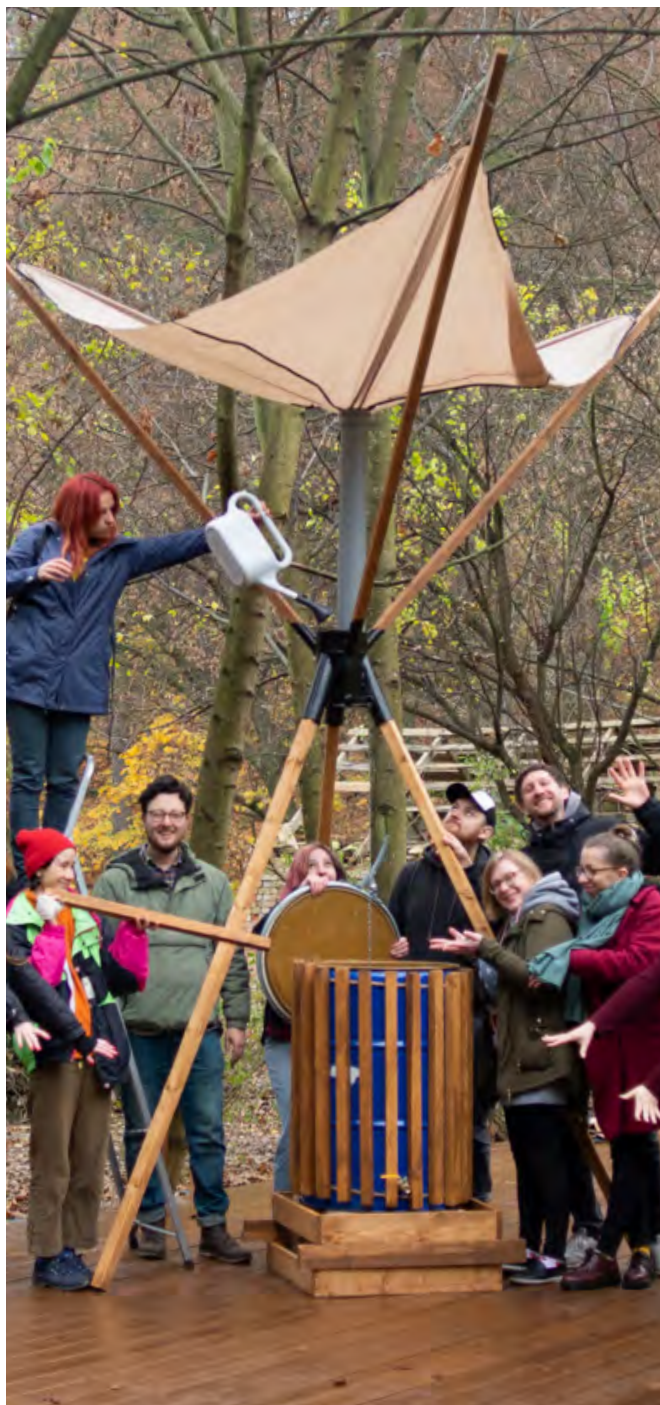
Експериментальний уловлювач і збірник дощової води в просторі "Розсадник" (Львів)
